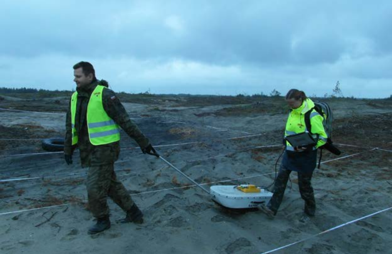
Badania z użyciem geosondy umożliwiły wykrycie niebezpiecznych przedmiotów na większej głębokości. © Gmina Klucze
